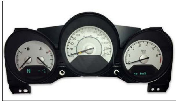
Ausfall der Hintergrund-Beleuchtung
