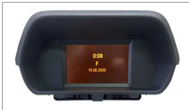
Pixel- oder Segmentfehler bzw. Verblässen der Anzeige
