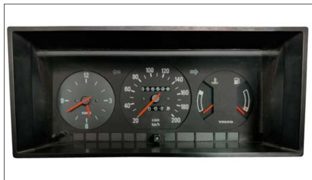
Gesamtwegstrecke wird nicht weitergezählt
