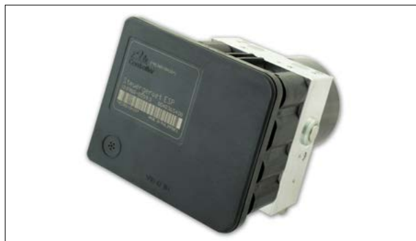
ATE MK60 - Fehler: „Bremsdrucksensor defekt“
