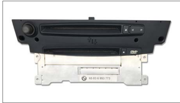
Sporadischer Totalausfall, Boot-Loop (kein 48-Stunden-Service)
