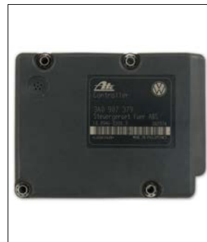
Diverse Fehler (z.B. keine Kommunikation oder Fehler „Radsensor defekt“)
