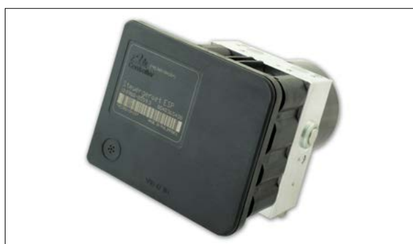
ATE MK60 - Fehler: „Bremsdrucksensor defekt“
