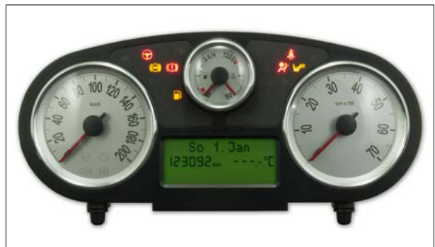
Pixel- oder Segmentfehler bzw. Verblässen der Anzeige
