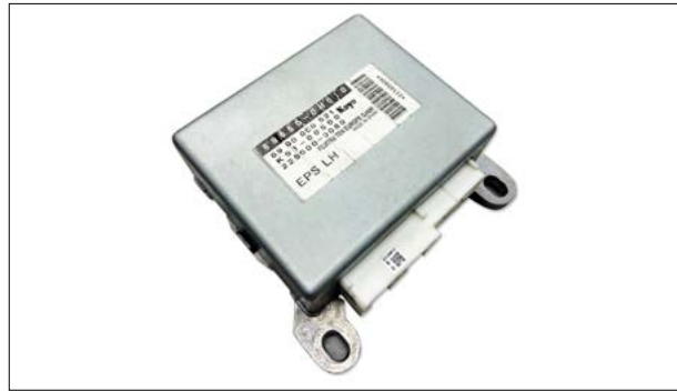
Sporadischer oder permanenter Ausfall der elektrischen Lenkunterstützung
