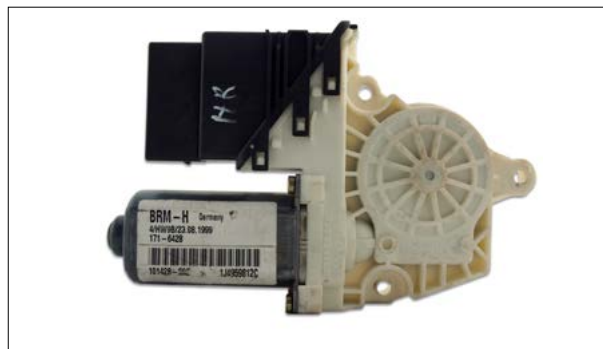
Sporadischer Ausfall der elektrischen Fensterheber
