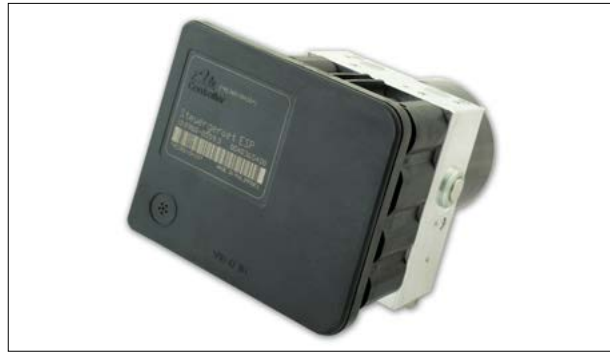
ATE MK60 - Fehler: „Bremsdrucksensor defekt“
