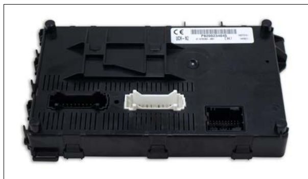
Beispiel-Bild (BSI | UCH | Zentralelektrik)
