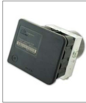
Fehler: „Bremsdrucksensor defekt“ Ausfall des Warnsummers
