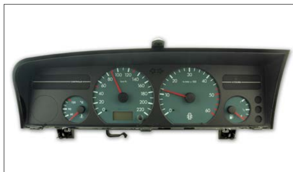
Fehlerhafte Analoganzeigen KMH/DZM
