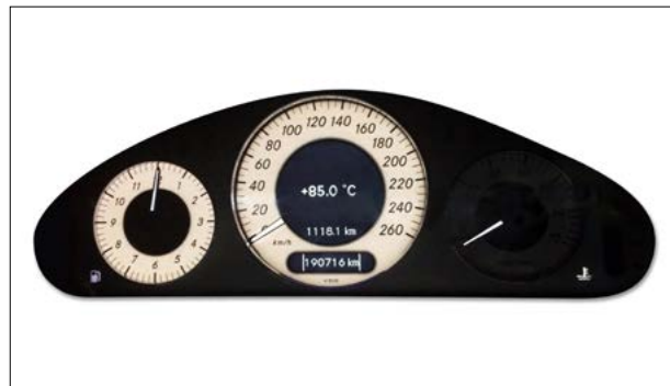
Ausfall der Hintergrund-Beleuchtung
