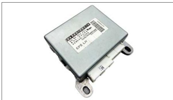
Sporadischer oder permanenter Ausfall der elektrischen Lenkunterstützung
