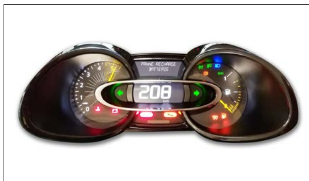
Pixel- oder Segmentfehler bzw. Verblässen der Anzeige
