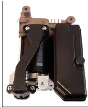
Luftfederung der Hinterräder ohne Funktion
